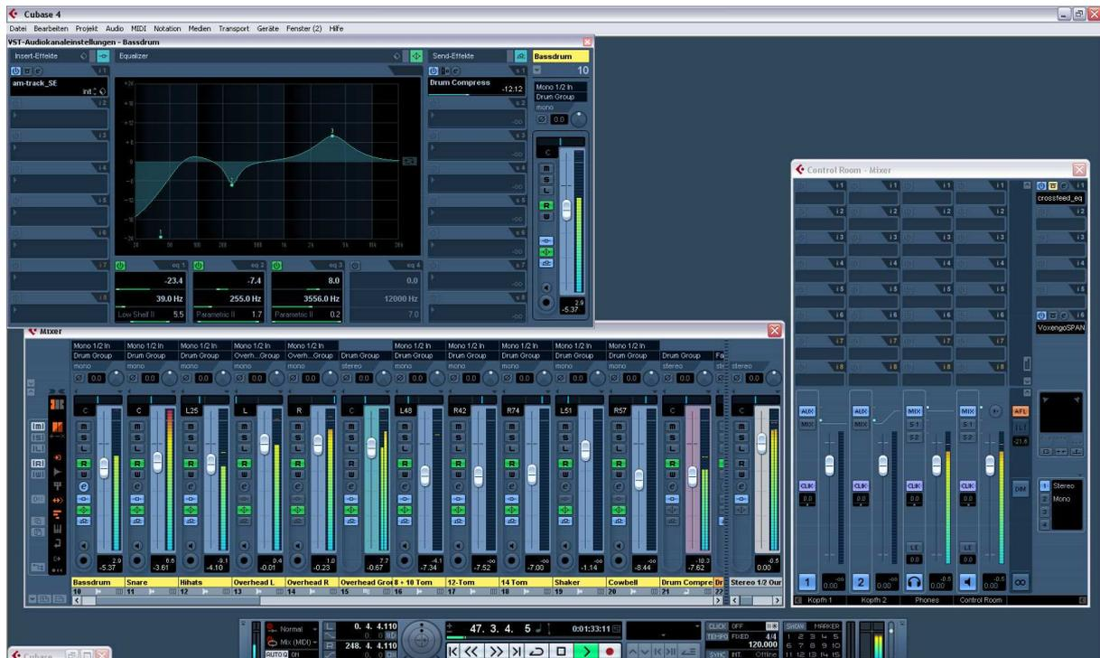
**Abbildung 15:** Ordnung im Mixerfenster. Unten der Hauptmixer, reduziert auf die wesentlichen Bedienelemente, darüber der komplette Kanalzug des gerade ausgewählten Kanals mit EQ, Send- und Insert-Wegen. Rechts der Control-Room-Mixer mit Fadern für die Monitore, Kopfhörer usw.
