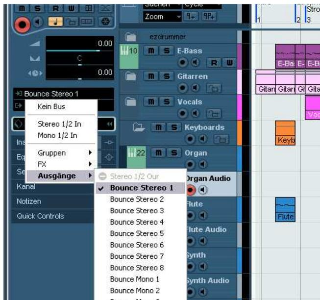
Abbildung 11: Auswahl eines virtuellen Ausgangs als Eingang der Zielspur.
