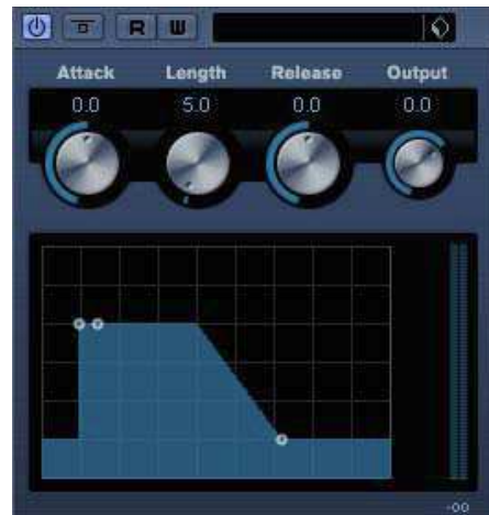
Abbildung 5: EnvelopeShaper von Cubase – ein Werkzeug zur Transientenbearbeitung
