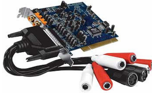
Abbildung 2: Audio-MIDI-PCI-Karte mit Kabelpeitsche und aufgetrennten Anschlüssen
